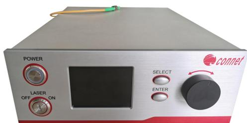
上海瀚宇的 VENUS 系列 915nm 多模泵浦激光光源采用内置隔离的激光器，能够实现对 1030~1090nm 波段反向 ASE 光大于 30dB 的隔离，避免 ASE 光对泵浦激光器的损坏。特有的 AWL (Active Wavelength Locking) 主动波长锁定技术，保证光源从半功率到全功率输出的情况下，峰值波长“锁定”在 915+/-3nm 范围内，提升了光源波长的稳定性和使用效率。
